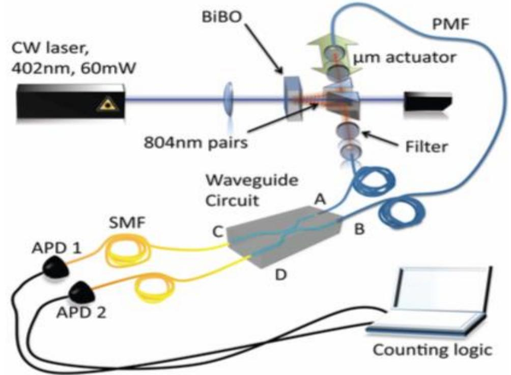
Fotones recibidos en el chip mediante SMF (Single Mode Fibers)
