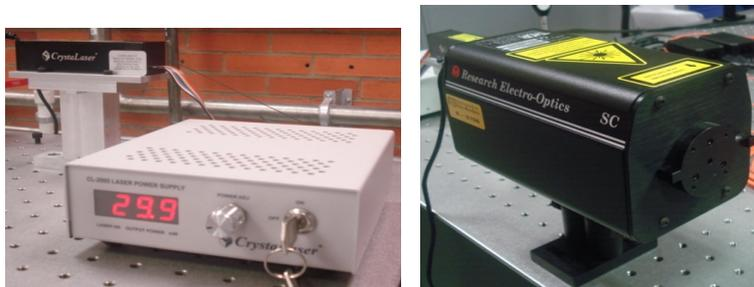
Figura 2: Láser principal, longitud de onda 405nm.
