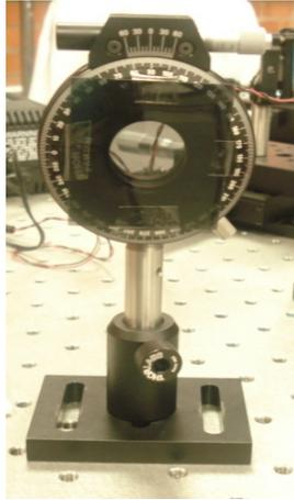
Figura 5: Polarizador usado para filtrar el aro de radiación.
