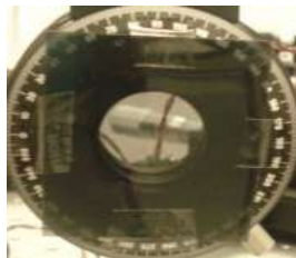
Figure 9: Polarizador usado para filtrar el aro de radiación.
