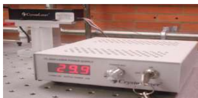
Figure 5: Láser de longitud de onda 405nm al fondo (negro). Fuente del láser al frente.
