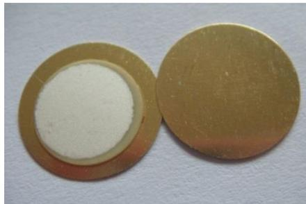
Figura 8. Piezo-eléctrico tipo moneda utilizado en los zumbadores o buzzers que se consiguen comercialmente a un precio realmente bajo que no supera los COP\$2000.
