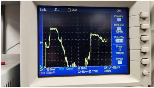
Figura 11. Señal de resta de los fotodetectores  $P_1-P_2$  para una traslación de la muestra. En la imagen se puede notar la fluctuación errática de la señal centrada en un punto.
