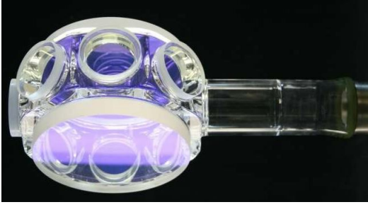
Figure 7: Foto de la celda usada típicamente para una MOT, la cuál tiene ventanas laterales para los haces y un tubo que permite la conexión con un sistema de vacío. Imagen tomada de Precision Glassblowing.
