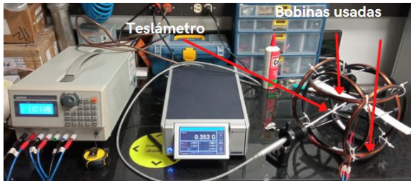
Figure 13: En esta figura se observa el montaje y equipos usados para medir el campo magnético usando los tres pares de bobinas en la configuración de Helmholtz ya implementada en el laboratorio.
