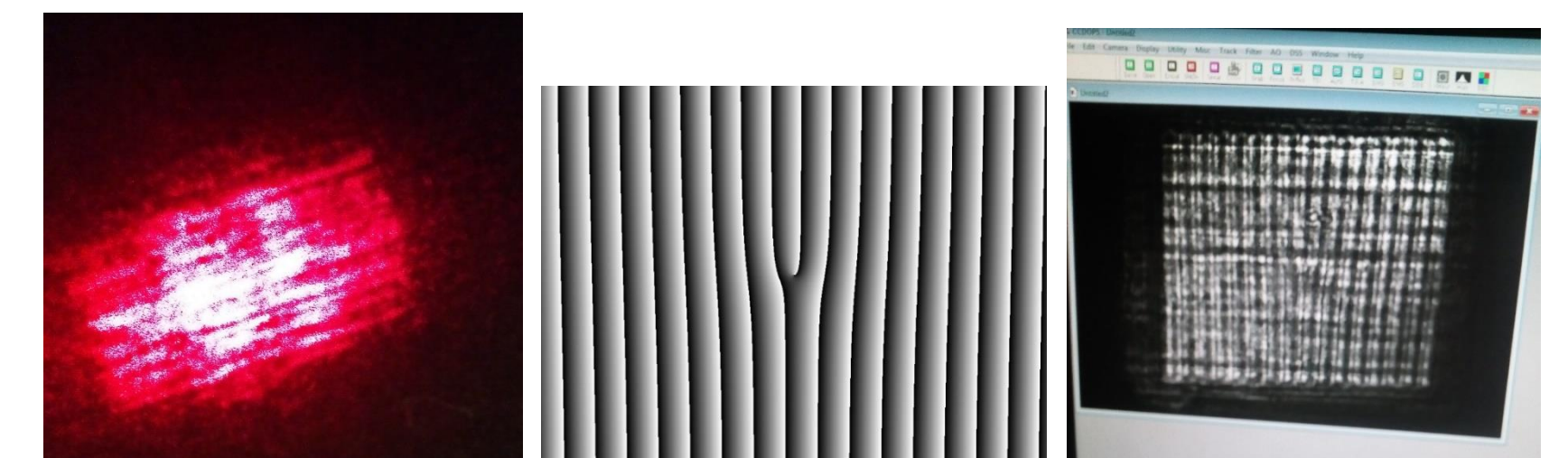
Figura 10: Izaq. Haz reflejado que cubre la pantalla del SLM. La imagen es la misma si el SLM esta o no activado. Cent. Imagen que se envía como segunda pantalla desde el computador. Der. Imagen de pantalla LCD del SLM.
