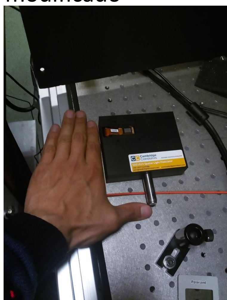
Figura 3: SLM SDE 1024 de Cambridge Correlators de la Universidad de los Andes
