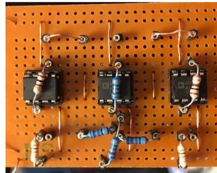
FIG. 9: Circuito restador usando amplificadores operacionales AD620 implementado en baquela electrónica. Las señales de entrada son aisladas con seguidores de voltaje construidos con LM741
