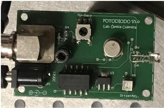
FIG. 6: Fotodiodo con su respectivo circuito. A través de un potenciómetro es posible variar la amplificación de la señal y así ajustarlo a la intensidad de fuentes a estudiar.
