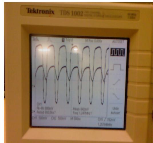
FIG. 9: Señal observada en el osciloscopio al usar un LM555 como circuito oscilador y zener como regulador
