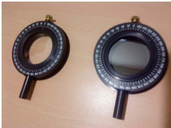
Figura 2. Lámina de cuarto de onda (izq) y Polarizador lineal (der)
