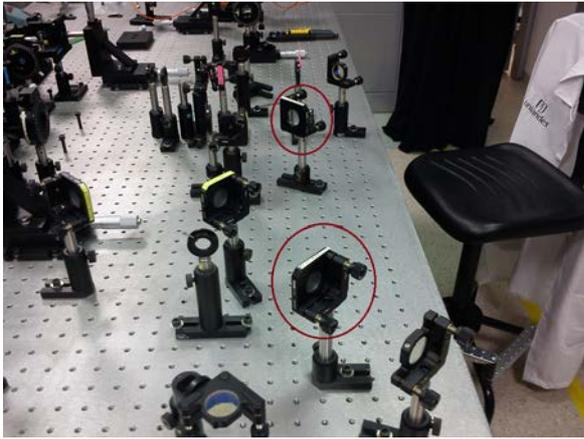
Figura 3: Imagen que muestra los dos espejos usados para alinear y cambiar la trayectoria del rayo de luz que sale del láser y llega al beam splitter.
