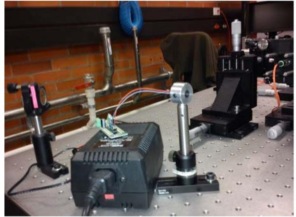
Figura 1: Imagen del láser utilizado en el experimento, la lámina de onda y el beam splitter no están frente al láser.
