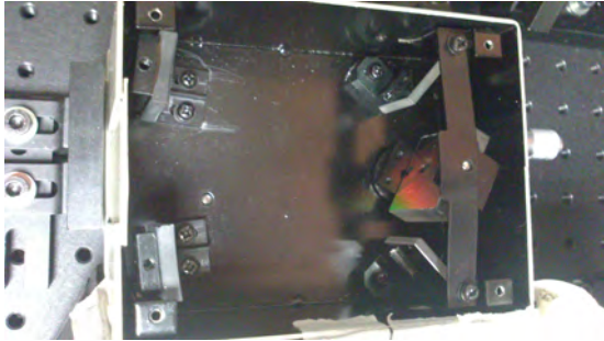
Fig 7. Interior del monocromador LEOI-92.
