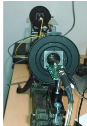
Imagen 2. Vista lateral del montaje. Se observa la disposición del portador de fibra, el polarizador y el fotodiodo.
