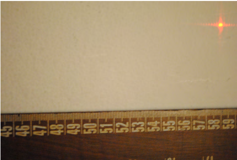
Figure 6: Calibración manual utilizando una regla sobre el patrón de difracción.
