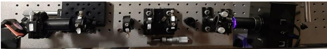
Figura 8: Montaje experimental en la mesa óptica: polarizador, filtro espacial  $L_1=100\text{mm}$   $\text{PH}=100\mu\text{m}$  y  $f_2=50\text{mm}$ , lente  $f_3=125\text{mm}$ , BBO TII, polarizador y CCD.
