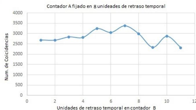
Figura 16: Contador A fijado en 8 unidades de retraso y barrido del contador B en unidades de retrasos del 1 a 10
