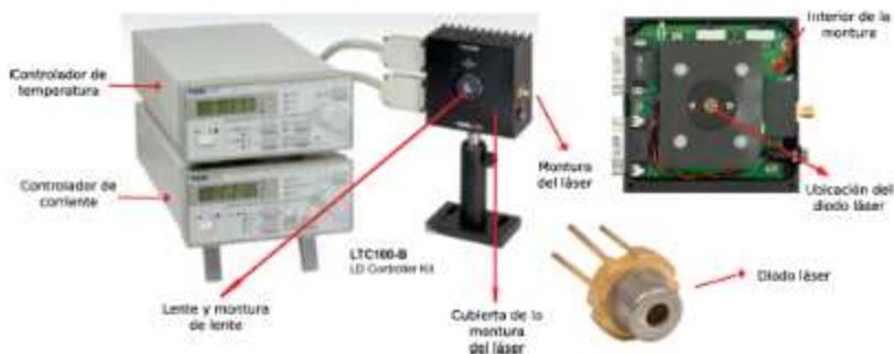
Figura 1: El láser cuenta con cuatro partes principales, controlador de temperatura, controlador de corriente, diodo láser y montura. Cada una de estas partes se configura de acuerdo a las especificaciones que da Thorlabs, el fabricante de este sistema, para el correcto funcionamiento del láser.
