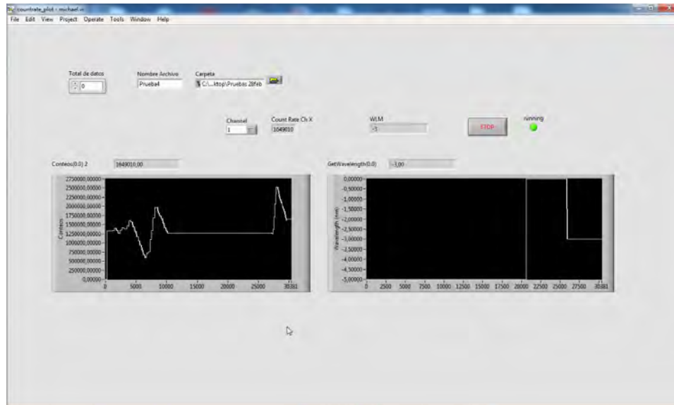
Figura 2.7: Programa en LabView que realiza de forma sincrónica la medida de la longitud de onda y el conteo de fotones durante el periodo del barrido. La gráfica de la izquierda muestra la longitud de onda en función del tiempo de barrido, y la gráfica de la derecha muestra el conteo de fotones en función del tiempo. Luego de la toma de datos, se pueden exportar de forma que se pueda graficar la señal de fluorescencia en función de la longitud de onda. En este caso se enseñan gráficas para ejemplificar el funcionamiento del programa y no muestran nada sobre la física del experimento.
