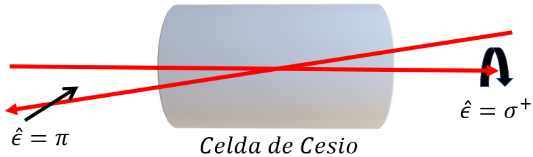
Figura 3.4: Imagen gráfica del estudio de la anisotropía en un gas atómico. En este caso se utiliza dos haces de luz láser con polarización \sigma^+ y \pi y una muestra atómica de Cesio.
